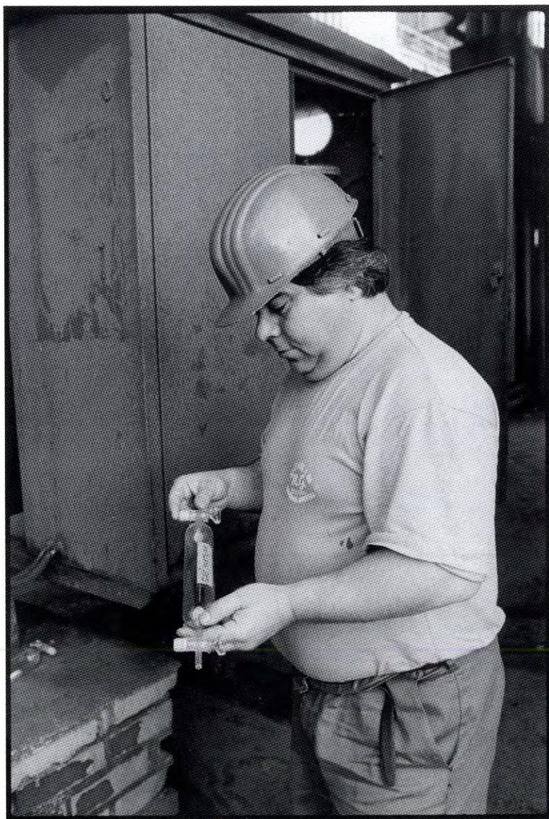
14) O operador de cowpers a recolher amostras de gás de mistura para análise.
