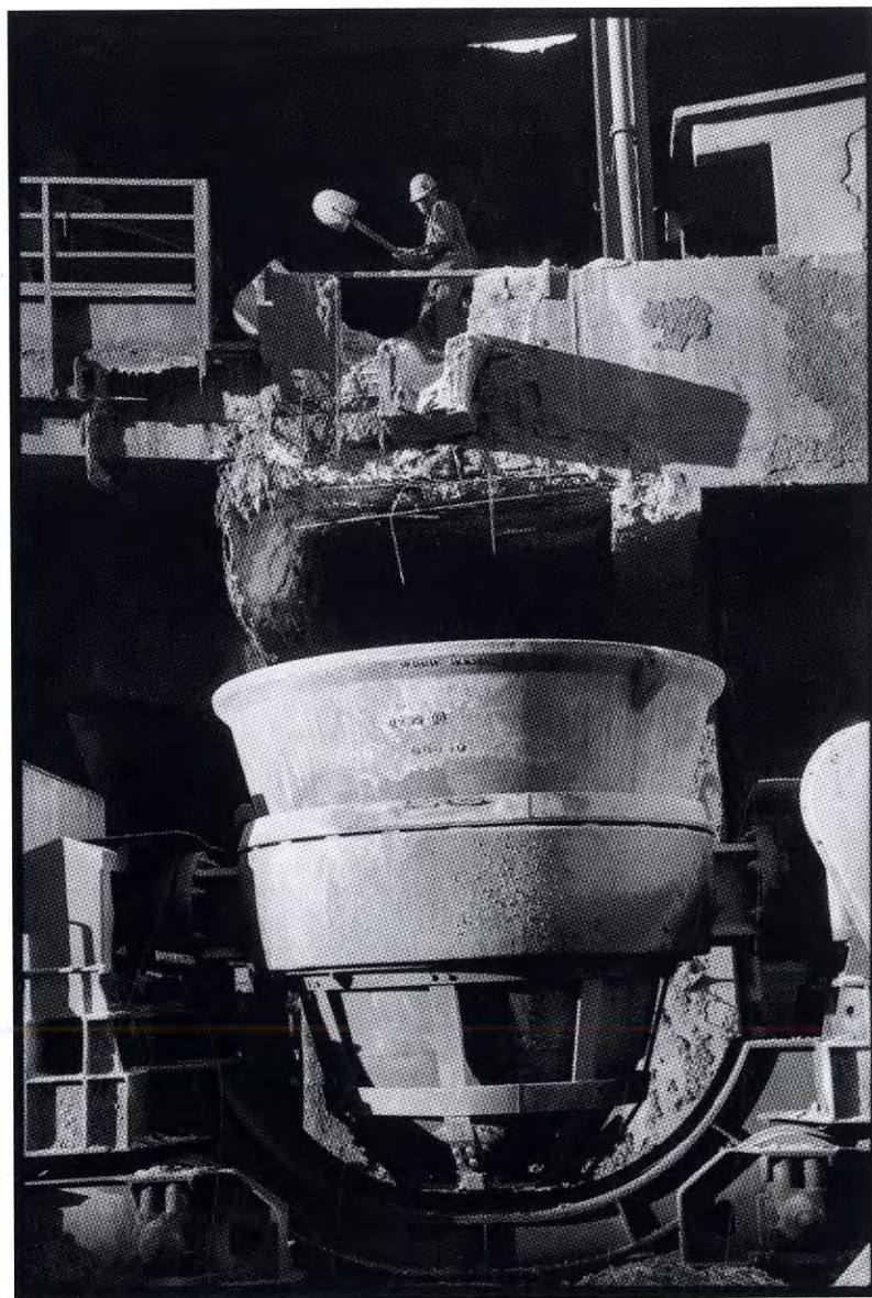
22) Trabalhador auxiliar a efectuar a limpeza da rina da escória. No plano inferior, uma panela da escória sobre o respectivo carro
