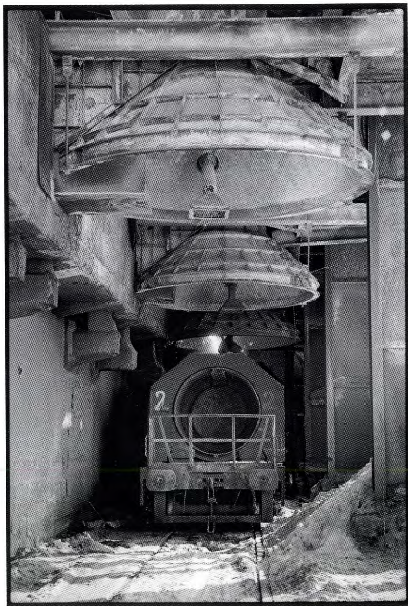
29, Enchimento de vagão torpedo com gusa
