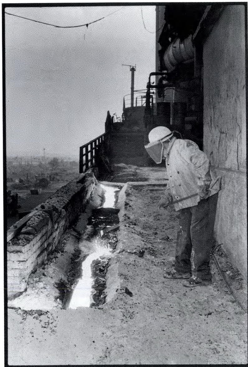
30 Virador de painelas a efectuar o encaminhamento da escória na respectiva rina
