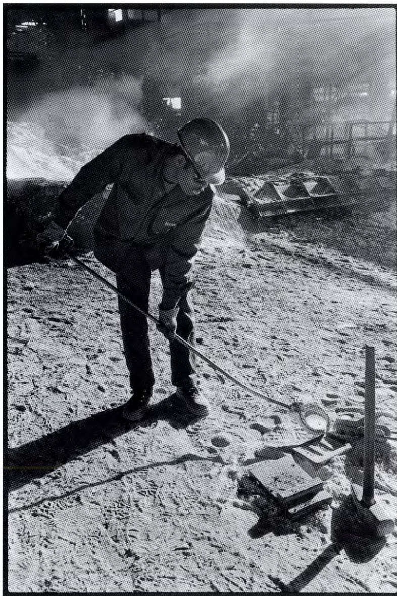
26) Trabalhador auxiliar a proceder à recolha de amostras de gusa para análise
