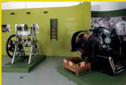
Aspecto da exposição temporária Cortiça ao milímetro – em primeiro plano: máquina de laminar cortiça da marca Trill (Palafrugell). © EMS/CDI – António Silva, 2008.
